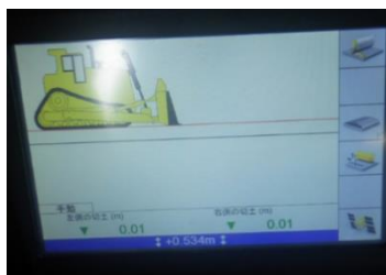
ドーザー運転席内のモニター
